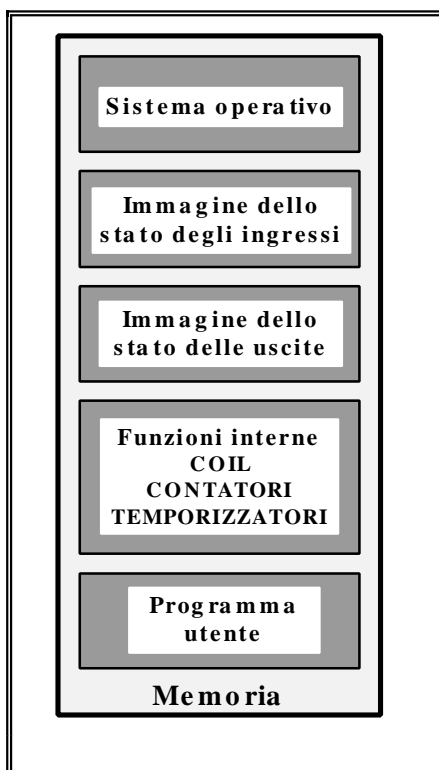
Figura 4 - Le istruzioni che costituiscono il programma sono registrate in memoria una dopo l'altra, in modo sequenziale. Ogni istruzione è codificata in binario. Nello esempio a ogni istruzione logica corrisponde una parola binaria di 16 bit. I 4 bit più significativi rappresentano il codice operativo (STR=1010, ANDNOT=1011, ecc.). I rimanenti bit rappresentano l'indirizzo dell'operando o l'operando stesso.
